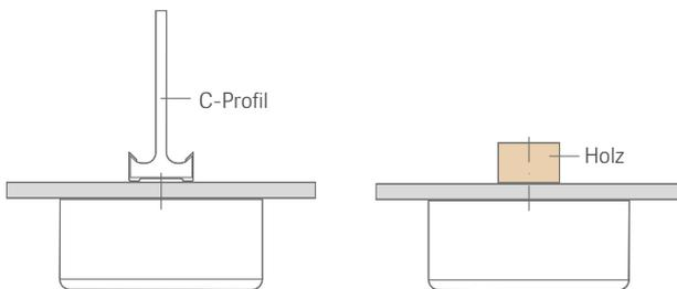
**e)** Für die Abhängung von Aufbauleuchten unter sichtbaren Systemen eignen sich z.B. die Schraubklammen Nr. 95/15, Nr. 95/30 bzw. Nr. 95/35.
