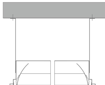
**b)** Die Konstruktion der Unterdecke ist mit zusätzlichen Abhängungen auszustatten, wobei zwei Abhänger je Einbauteil das Minimum darstellen. Die zusätzlichen Abhängungen sind unter Punkt 5.2 auszuwählen. Die Traglast ist zu berücksichtigen. Ebenso ist Rücksicht auf die eventuelle Überlastung von Profilen zu nehmen.
