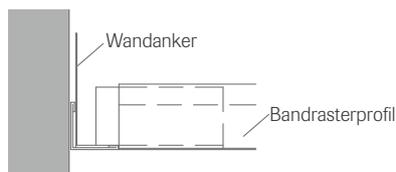
Durch den Einbau von Wandankern lassen sich Bandrafterprofile genau fixieren. Die Wandanker sind mit den Raumbegrenzungsflächen zug- und druckfest zu befestigen. Um die Längendehnung der Bandrafterprofile ausgleichen zu können, ist eine Dehnfuge von ca. 0,5 ... 1,0 mm zu berücksichtigen.
