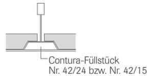
**Diese Teile sind nur zum Schließen der trapezförmigen Öffnungen und nicht für Lastabtragungen verwendbar.**
