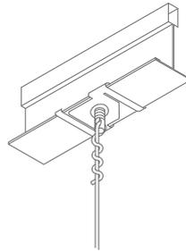
Wichtig ist hierbei, dass die angegebenen Belastungen für die Befestigungsklammern nur dann nutzbar sind, wenn das Profil zusätzlich abgehängt ist. Über Verbindungsprofile sind nur dann Lasten abtragbar, wenn diese zusätzlich abgehängt werden.
