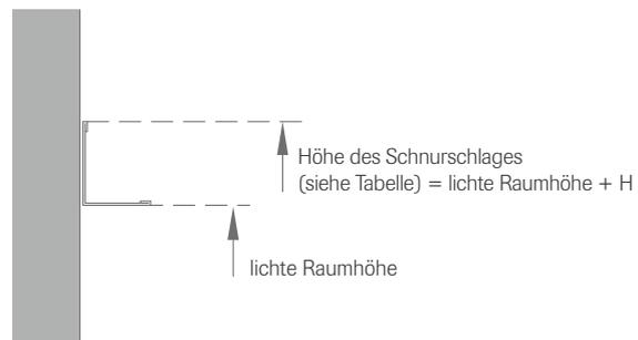
**Das Befestigen sämtlicher Wandprofile erfolgt im Abstand von max. 300 mm und ist von der Belastung abhängig.**
