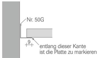
Vom Markierungsriß ausgehend sind +9 mm für das Ausfälen zuzugeben und an dieser Linie ist die Platte scharfkantig mit dem OWA-Messer Nr. 99/01 abzuschneiden.
