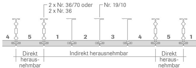
Werden ausschließlich C-Profile Nr. 36, Nr. 36/70 oder L-Profile Nr. 37 verwendet, ist jede Platte direkt herausnehmbar.
