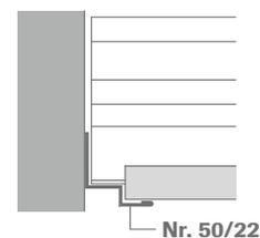
freigesp. Decken, z. B. Flurdecken mit Contura-Platten nach System S 6b
