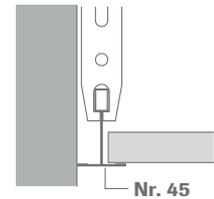
Für Punktlast bis max. 0,07 kN.
