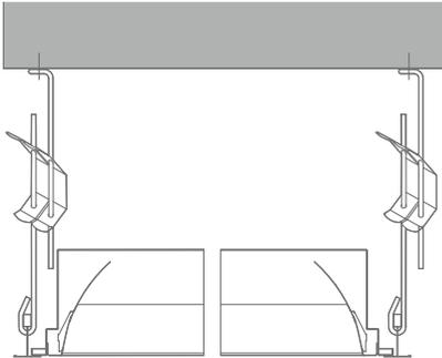
**c)** Eine weitere Möglichkeit stellt das Einbringen einer Hilfskonstruktion in Form von abgehängten C-Profilen oder Holzkonstruktionen dar. Brandschutztechnische Anforderungen sind ggf. zu beachten.
