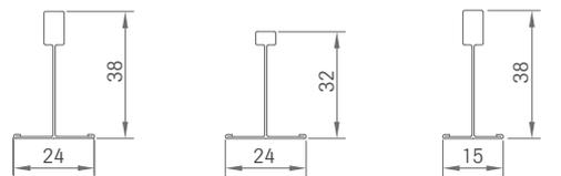
S 3 cliq / S 3a cliq Tragprofil      Verbindungsprofil      Verbindungsprofil
