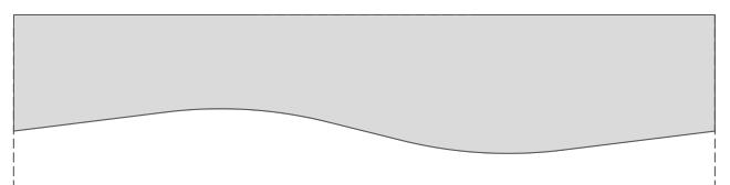
Die Strichlinie bildet die maximal mögliche Größe (2400 x 600 mm) ab. Alle Formen müssen vorher auf Machbarkeit geprüft werden. Absorptionswerte und benötigtes Montagezubehör abhängig von gewünschter Geometrie.
