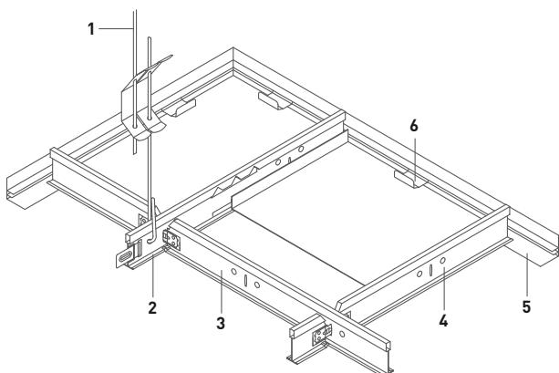
Bei Verwendung von auflaufenden Querprofilen kann es bei Kantenausbildung K03 im Stoßbereich zur Bildung von Schattenfugen kommen. Dies ist system- bzw. bauartbedingt und berechtigt nicht zu Reklamationen.
