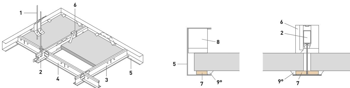
Eingelegte OWAcoustic Platten können mit Druckfedern Nr. 819 fixiert werden, um beim Reinigen ein Herausheben der Platten zu verhindern.
