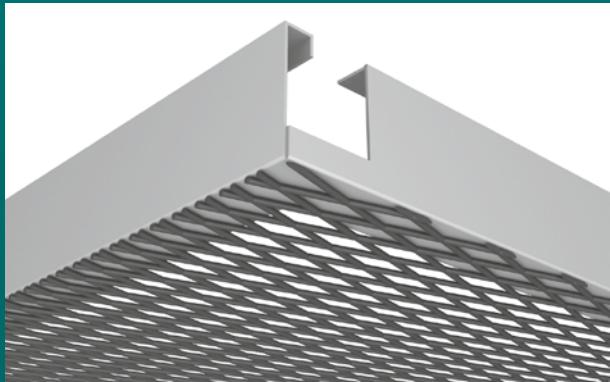
Mit L-förmigem Rahmen, hergestellt aus einer Langfeldplatte mit Ausschnitt, von hinten an die Streckmetallplatte angeschweißt.
