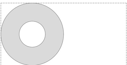
Die Strichlinie bildet die maximal mögliche Größe (2400 x 1200 mm) ab. Alle Formen müssen vorher auf Machbarkeit geprüft werden. Absorptionswerte und benötigtes Montagezubehör abhängig von gewünschter Geometrie.
