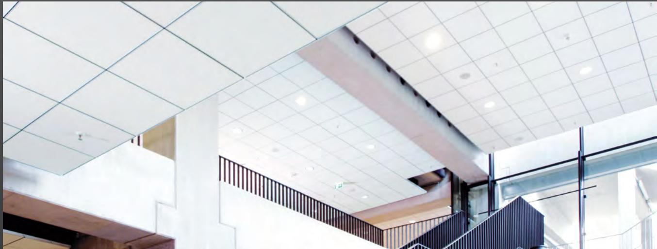
SICHTBAR, HERAUSNEHMBAR – 15 MM BREITE PROFILE MIT SCHATTENFUGE
