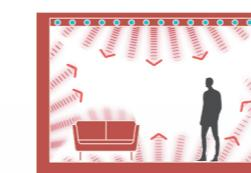
Les rails d'énergie frais absorbent la chaleur dans la pièce et l'évacuent avec l'eau.
