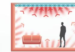
Toutes les surfaces de la pièce sont refroidies et permettent au corps de réguler sa température agréablement et sans transpirer.
