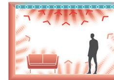
Alle Oberflächen im Raum sind abgekühlt und erlauben dem Körper eine behagliche Wärmeregulation, ohne zu schwitzen.
