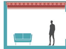
Die Wärme wird per Strahlung von den Energieschienen direkt an alle Oberflächen im Raum abgegeben.
