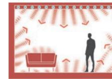
Die kühlen Energieschienen absorbieren die Wärme im Raum und führen sie mit dem Wasser ab.
