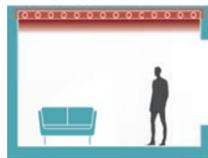
Die Wärme wird per Strahlung von den Energieschienen direkt an alle Oberflächen im Raum abgegeben.
