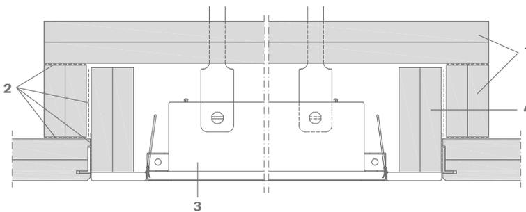
**Bei Verwendung von Fremdleuchten ist auf einen umlaufenden ausreichenden Rand zur Aufnahme des Barriere-Platten-Zuschnitts zu achten (siehe Schnitt). Wir empfehlen ausschließlich unsere OWAlifetime LED zu verbauen.**
