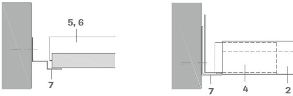
Détails raccord mural à la cloison en plaque de plâtre
