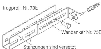
Nachdem die U-Profile exakt ausgerichtet sind, wird jede U-Profil-Reihe mit Hilfe des Wandankers Nr. 75E an den Wänden arretiert. Der Wandanker kann sowohl neben dem U-Profil (dargestellte Variante) als auch unter dem U-Profil angeordnet werden.
