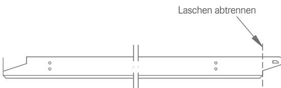
Im System S 32 können alle Platten abgeklappt werden, außer Randplatten. Für eine einfache Demontage der Randplatten müssen die „Laschen“ der Platten abgeschnitten werden.
