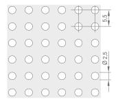
**Rg2516** | Ø 2,5 mm | 16 % freier Querschnitt
