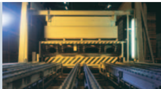
Die fertige Rohplatte verlässt den Trockner
