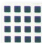
Aluminium met vierkante perforatie QL 5/8 met een vrije doorlaat van 39,1 %
